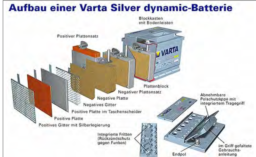
Bild 2.26: Explosionszeichnung einer Bleibatterie [varta-automotive.de]
